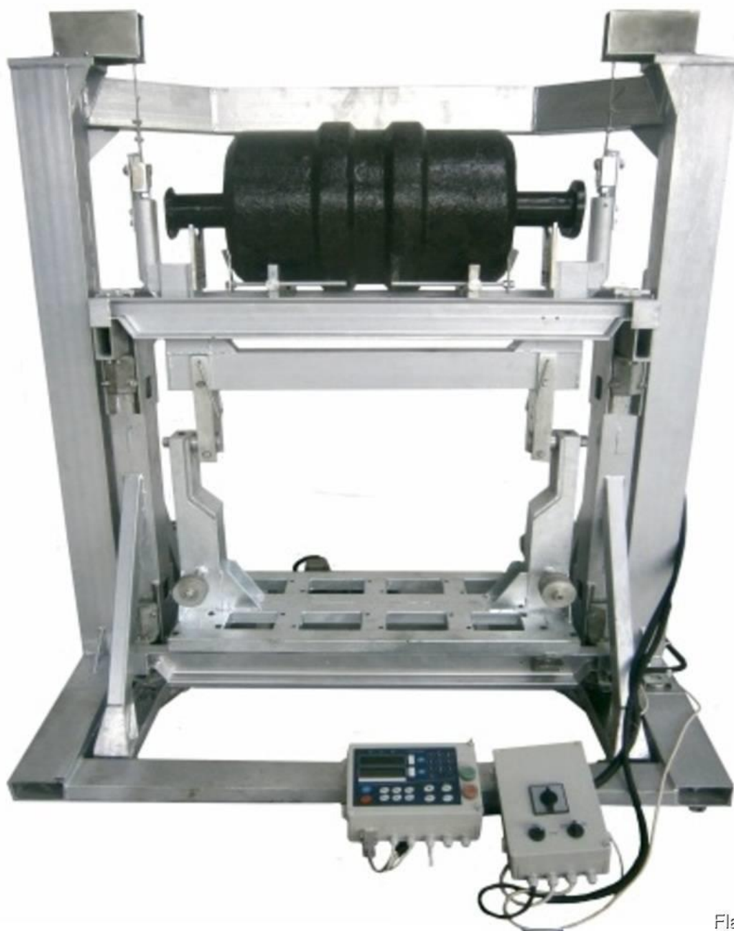
Рисунок 1.1 – Конструкція компаратора маси для гир більше 50кг
