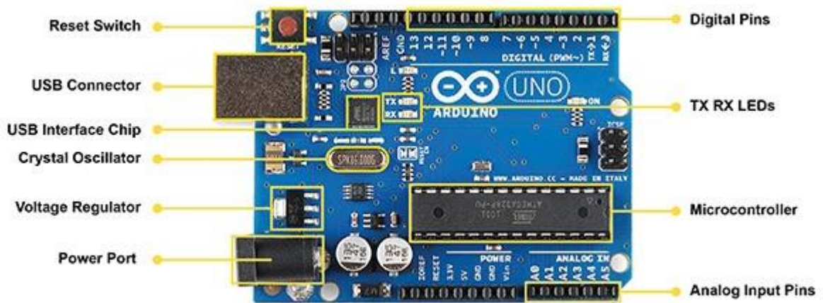
Рисунок 1.1 – Опис елементів плати Arduino Uno Rev3 [2]
