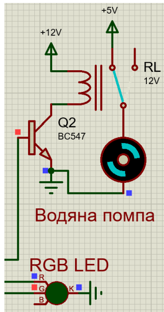
Рисунок 3.13 – Активний стан роботи помпи та ІЧ-датчика
