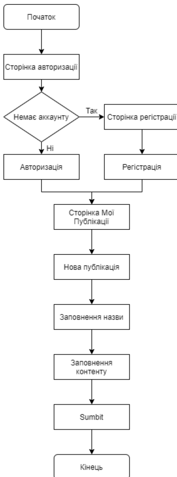
Рисунок 3.4 – Схема алгоритму створення публікації користувачем у програмному забезпеченні ІС для керування нотатками
