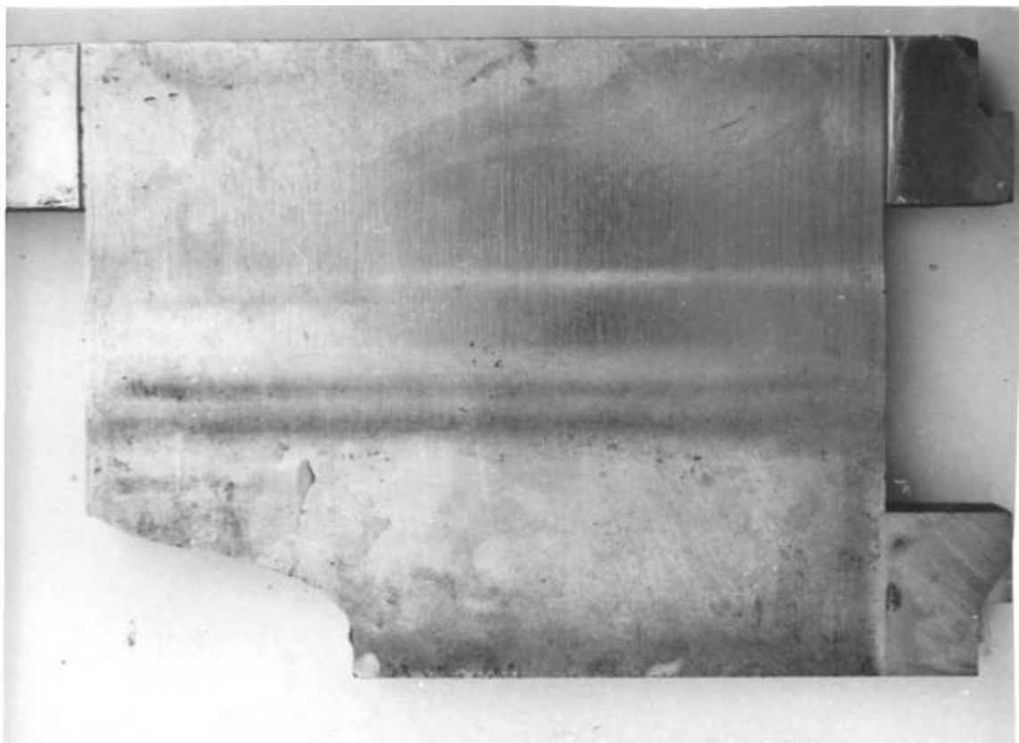
Рисунок 1.4 – Характерні руйнування пластин прес-форм
