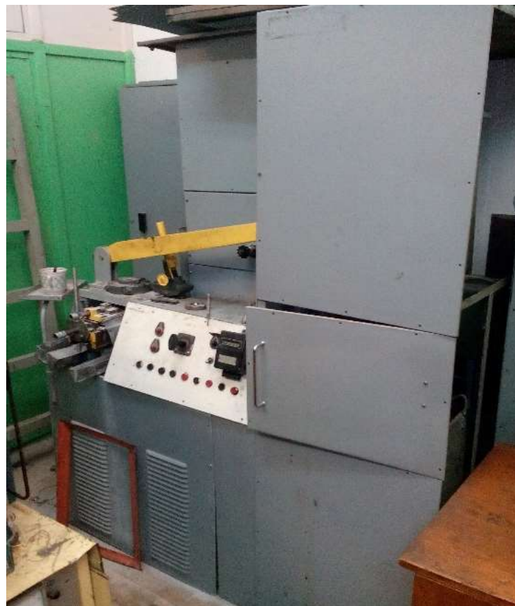
Рисунок 3.1 – Лабораторна установка для проведення дослідження зносостійкості деталей прес-форм
