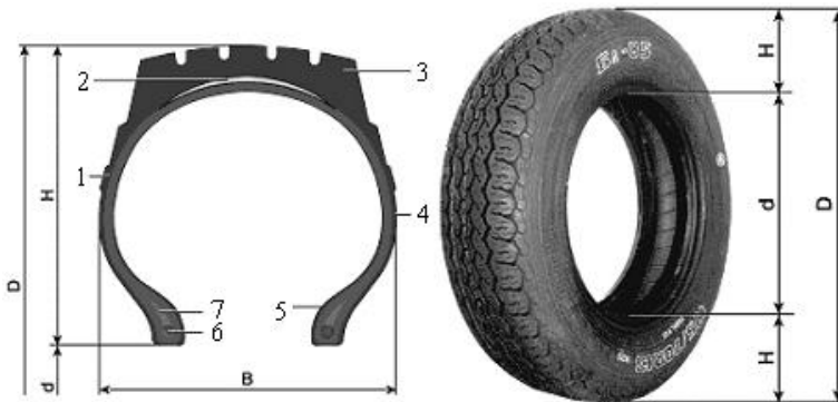
1 - каркас, 2 - брекер, 3 - протектор, 4 - боковина; 5 - борт, 6 - бортове кільце, 7 - наповнювальний шнур; D - зовнішній діаметр, H - висота профілю шини, B - ширина профілю шини, d - посадочний діаметр обода колеса (шини)
