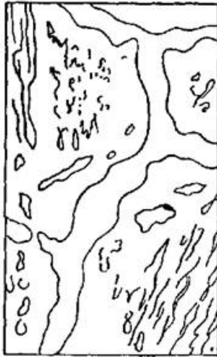
Рисунок 4.2 – Аномальна структура цементовної сталі (схема)
