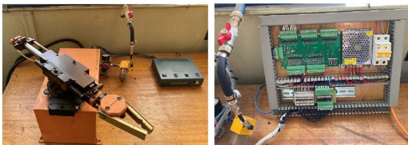
а б а – маніпулятор МП-9С та пульт ручного керування; б – мікроконтролерна частина лабораторного станду. Рисунок 1 – Мехатронна САК пневматичним маніпулятором.
