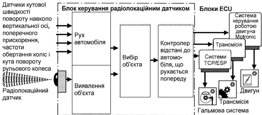
Рисунок 12.8 - Основна структура керування системи ACC
