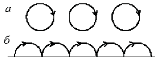
Рис. 9.18. Траєкторії двовимірних електронів у перпендикулярному магнітному полі в глибині зразка (а) та поблизу його межі (б)
