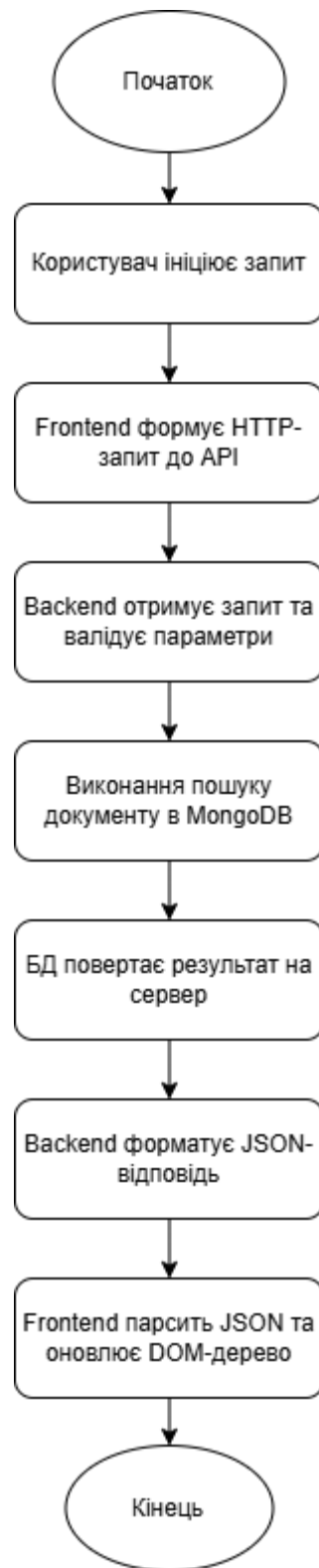
Рисунок 3.1 – Блок-схема базового алгоритму обробки клієнтського запиту
