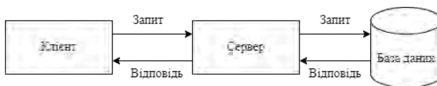
Рисунок 2.1 – Схема трирівневої архітектури
