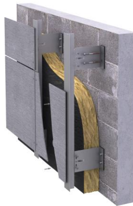
Рисунок 1.14 - Конструкція навісної вентилярованої системи з фіброцементними плитами
