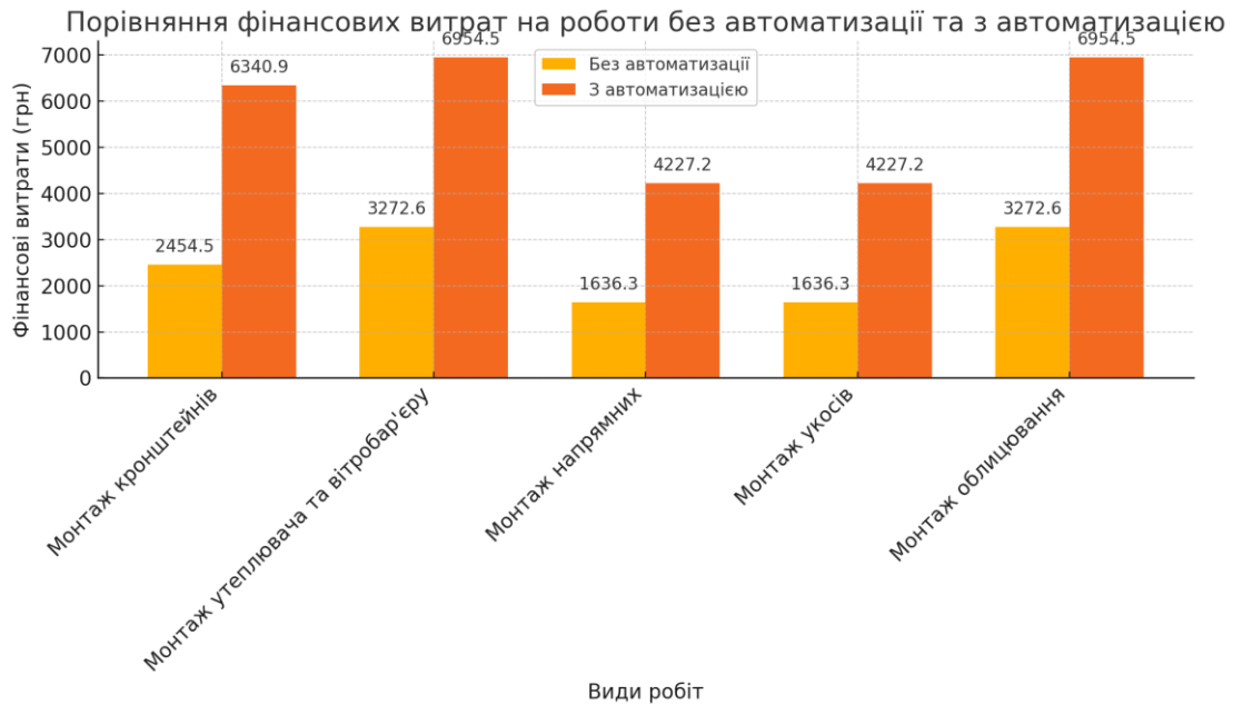
Рисунок 3.8 - Порівняння фінансових витрат на виконання кожного виду робіт із використанням лише людської праці (без автоматизації) та з використанням роботизованих систем
