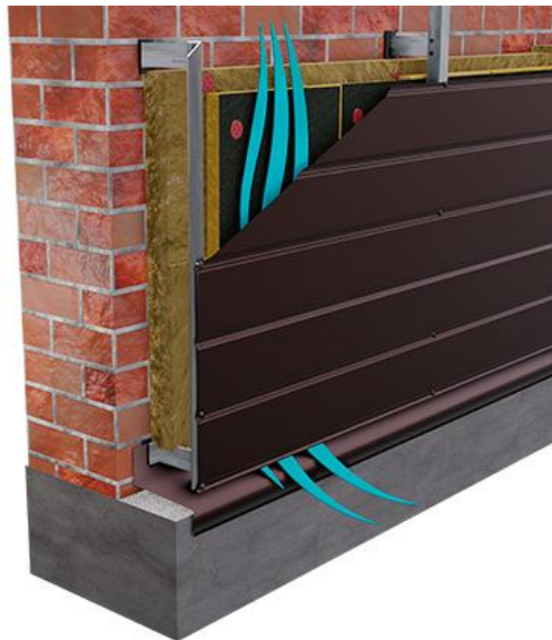
Рисунок 2.11 - Застосування мінвати при утепленні зовнішніх стін
