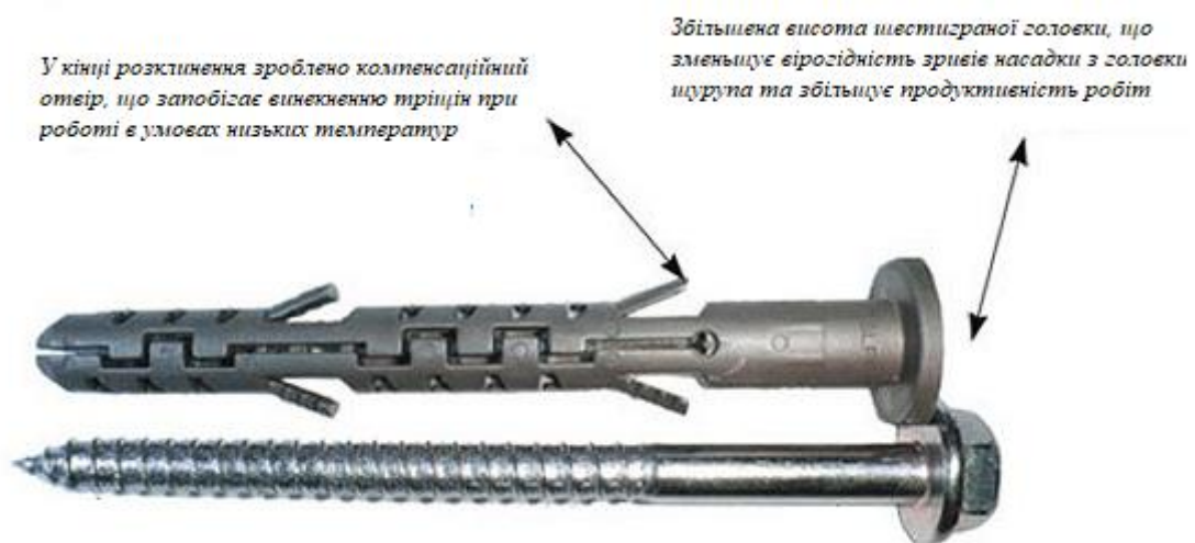
Рисунок 2.6 - Схема анкерного дюбеля
