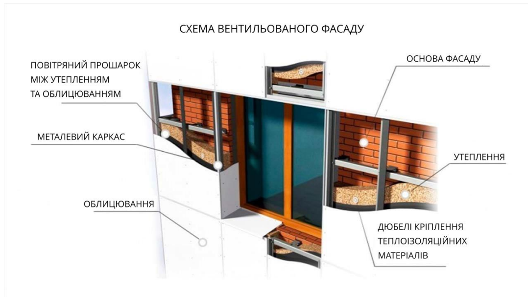
Рисунок 1.11 - Конструктивні елементи вентильованих систем утеплення фасадів
