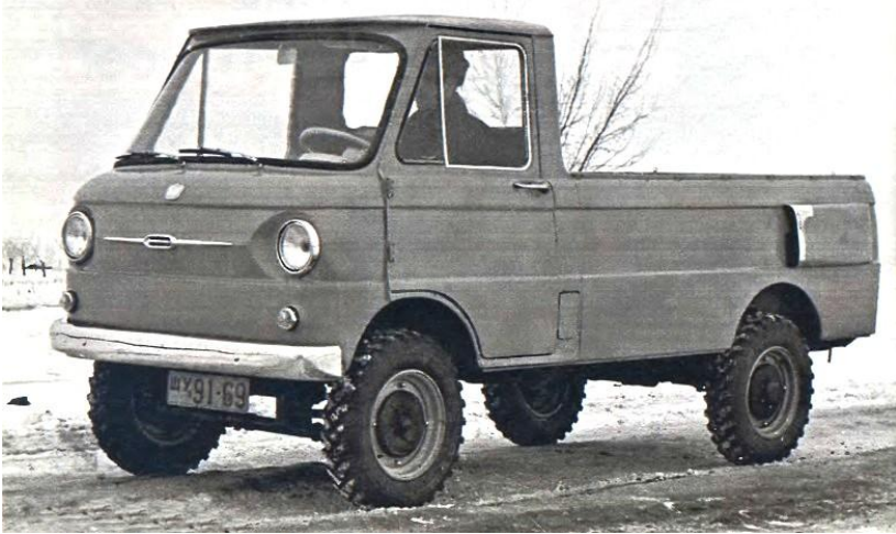
Рисунок 10.18 - Один з перших ЗАЗ-970Г на випробуваннях. Характерну підштамповку на боковинах, таку ж як на ЗАЗ-966, зробили, щоб не збільшувати повітрязабірники системи охолодження
