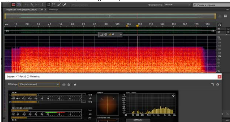
Рисунок 1 – Аналіз роботи двигуна ВАЗ-2101 із підвищеними зазорами у клапанному механізмі у робочому середовищі програми Adobe Audition CC
