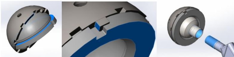
Рисунок 5 - Етапи зборки ендопротезу кульшового суглоба
