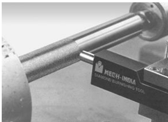
Рисунок 1.5 – Алмазне вигладжування на токарному верстаті [15]
