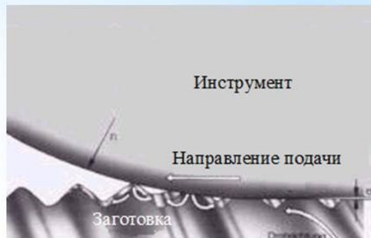
Схема деформації поверхні при вигладжуванні
