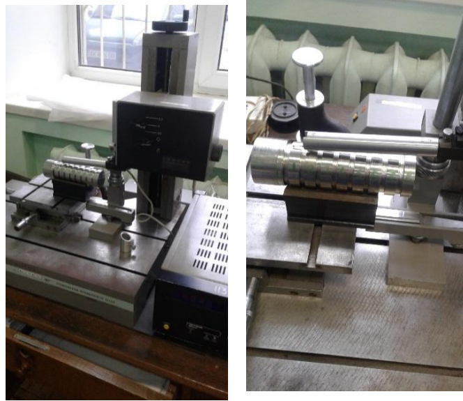
Рисунок 5.11 – Вимірювання шорсткості на профілометрі-профілографі
