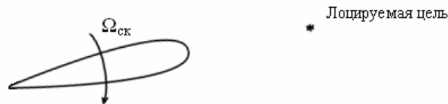
Рис. 2.13. Принцип приема сканируемой ДНА отраженных от цели сигналов
