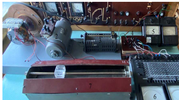
1 – торцевий генератор; 2 – привідний двигун; 3 – реостат регулювання збудження; 4 – комплект із випрямлячами та фільтрами; 5 – комплект приладів вимірювання в колі привідного двигуна; 6 – комплект приладів вимірювання торцевого генератора; 7 – навантаження торцевого генератора; 8 – вимірювач швидкості обертання торцевого генератора.
