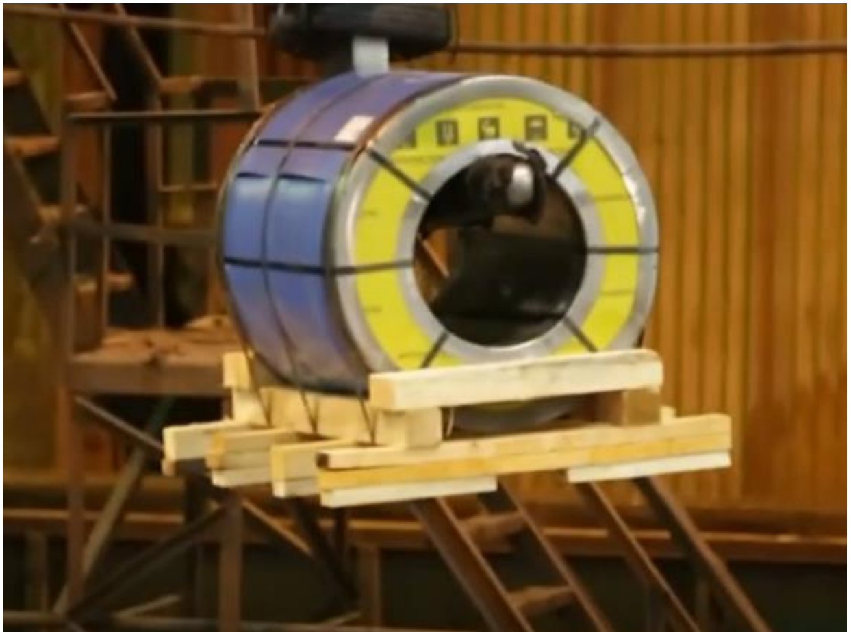
Рисунок 1.7 – Переміщення металопрокату за допомогою скоби електромостовим краном
