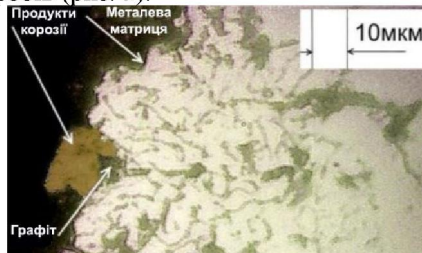
Рисунок 9 – Початкова стадія проникнення корозії в поверхню.
