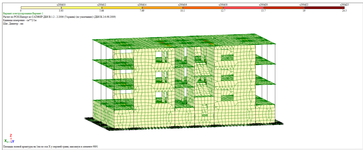
Рисунок 2.12 – Верхня арматура в пластинах по осі X
