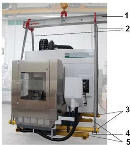
Рисунок 1.3 - Транспортування верстата підйомним краном
