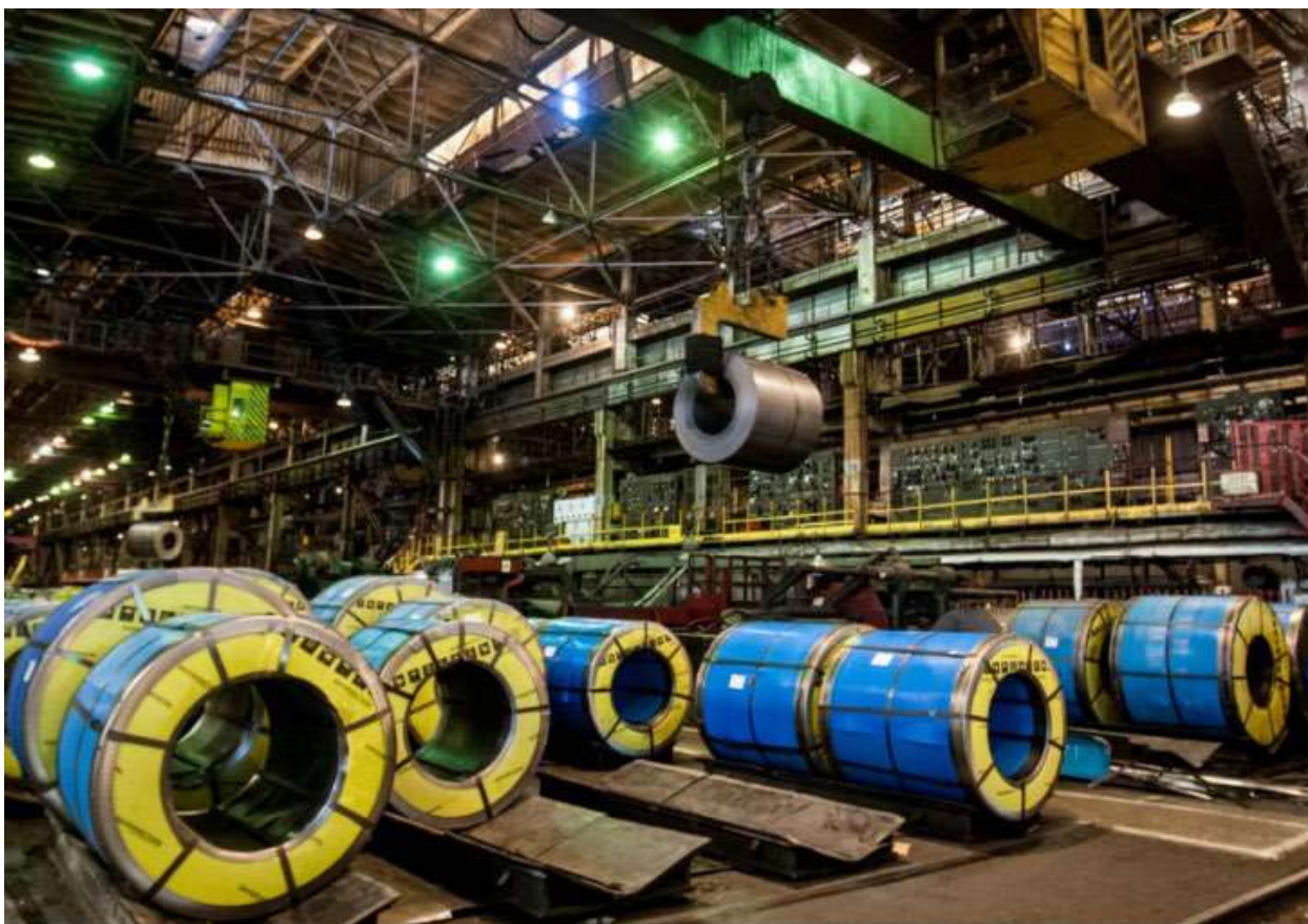
Рисунок 1.3 – Відвантаження металопродукції ЦХП-1 мостовими електричними кранами
