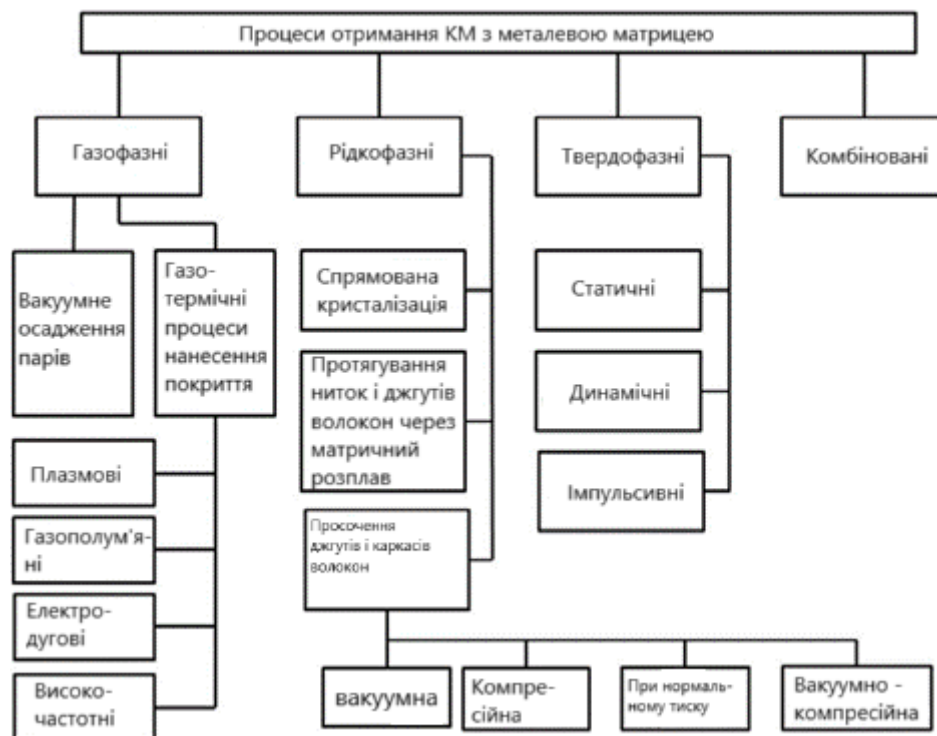
Рисунок 2.2 - Загальна класифікація процесів отримання та обробки композитів із металевою матрицею.
