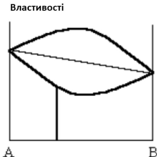
Рисунок 1.1 - Схема зміни властивості КМ залежно від властивостей компонентів та їхньої кількості
