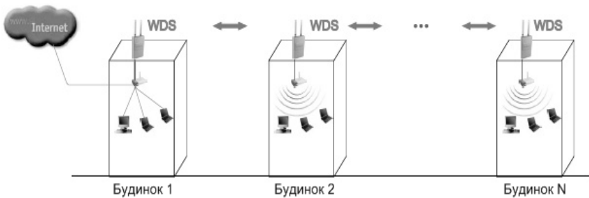
Рисунок 4.5 – Топологія типу "шина"
