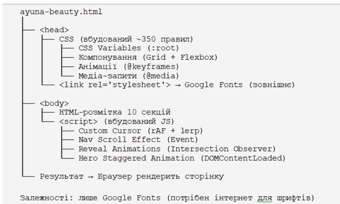
Рисунок 2.10 – Архітектура Single-File Application та потік завантаження
