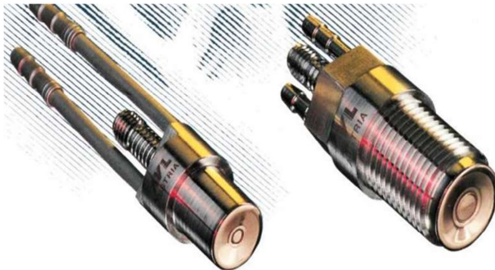
Рис. 5.8. П'єзоелектричні датчики серії QC і QH для вимірювання тиску в циліндрі
