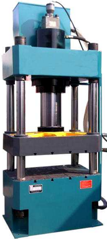
Рисунок 2.4 – Загальний вигляд гідравлічного кувального пресу
