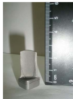
Рис. 11. Видавлена заготовка компресорної лопатки
