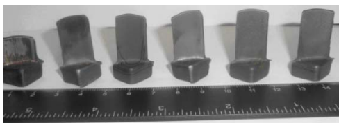
Рис. 9. Заготовки компресорних лопаток, отримані із поступовим збільшенням довжини пера
