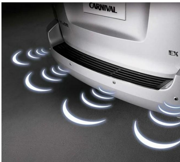
Рисунок 12.20 - Візуалізація роботи датчиків паркувальної системи
