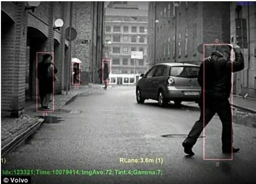
Рисунок 12.16 - Робота системи виявлення пішоходів Volvo
