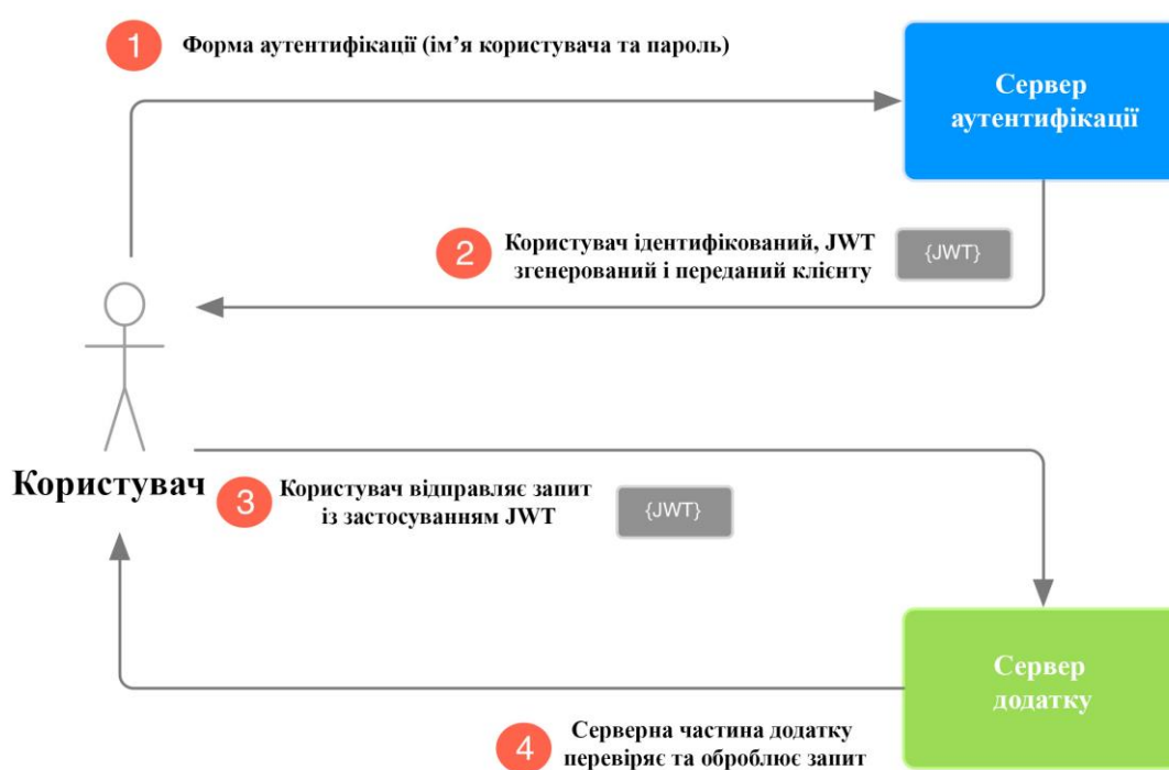
Рисунок 4.10 – Алгоритм застосування JWT
