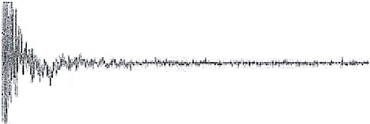
Рисунок 2.12- Типовий графік вібрації коробчастих напрямних (Box Way) з накладками Turcite універсальних токарних верстатів TC300
