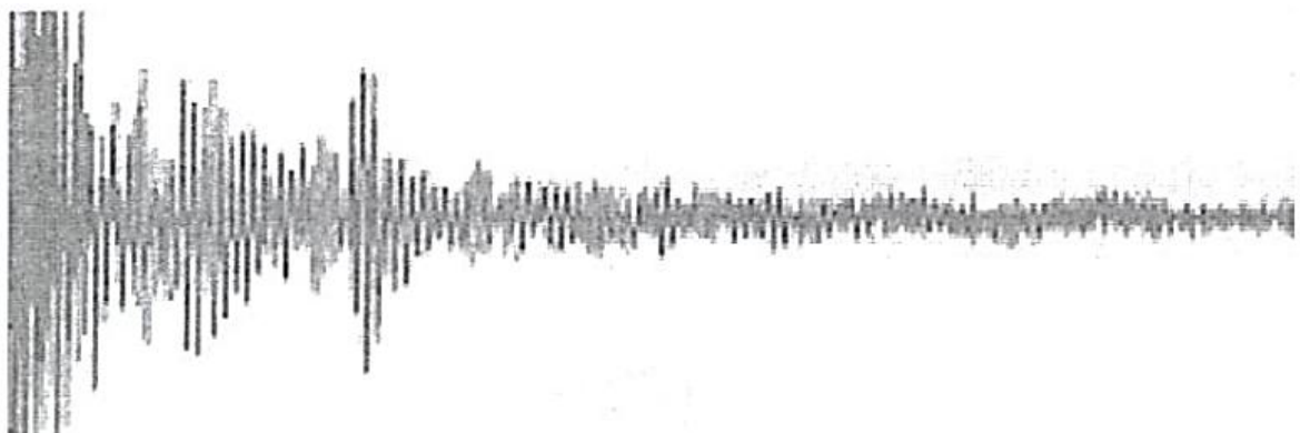
Рисунок 2.13 - Типовий графік вібрації лінійних напрямних кочення універсальних токарних верстатів TC300
