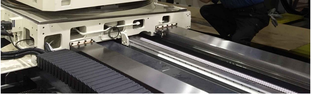
Рисунок 2.8– Вигляд коробчастих напрямних у верстаті
