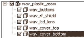
Рисунок 2.10 — Новий компонент в навігаторі збірки
