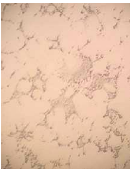
Рисунок 4.7 – Карбіди в дослідному сплаві ЖС32-ВІ, \times 100
