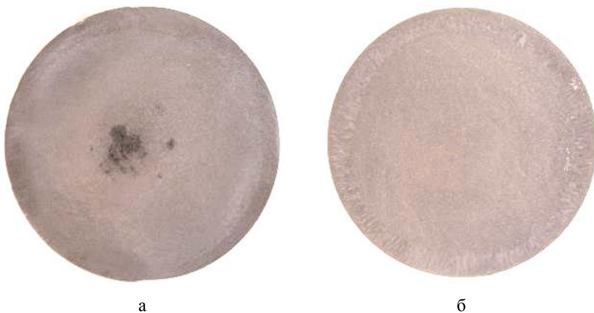
Рисунок 4.6 – Макроструктура заготовки діаметром 85 мм зі сплаву ЖС32-ВІ (поперечний переріз), \times 1
