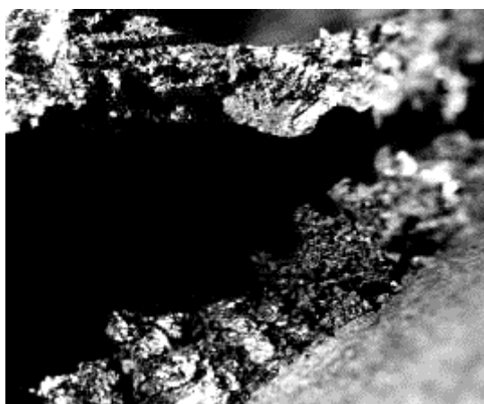
Рисунок 3.15 – Гаряча тріщина з боку внутрішнього (охолоджуваного) каналу лопатки зі сплаву ЖС26-ВІ
