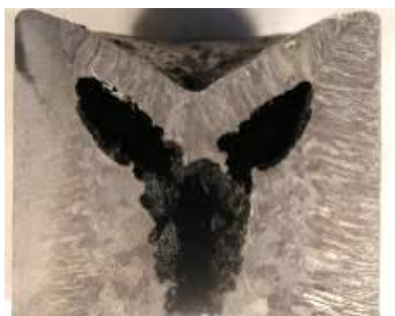
Рисунок 4.1 – Макроструктура в осьовому перерізі верхньої частини пруткової заготовки Ø 105 мм зі сплаву ЖСЗЛС-ВІ, \times 0,5
