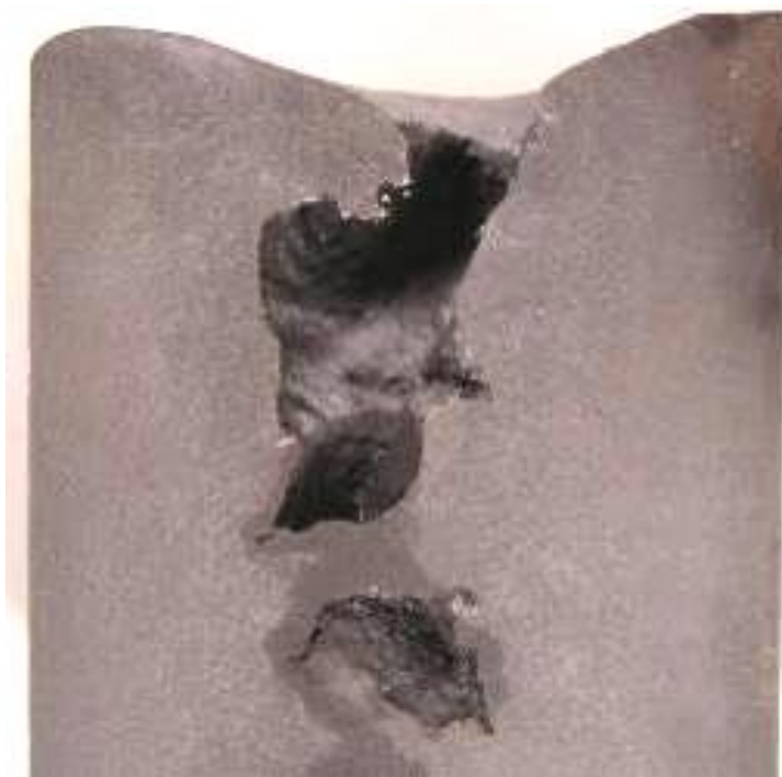
Рисунок 4.5 – Макроструктура верхньої частини пруткової заготовки діаметром 85 мм зі сплаву ЖС32-ВІ (осьовий переріз), × 1
