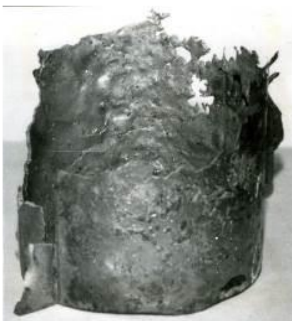
Рисунок 3.30 – Зовнішній вид гарнісажного шару над верхньою частиною зливку ВІП+ЕПП
