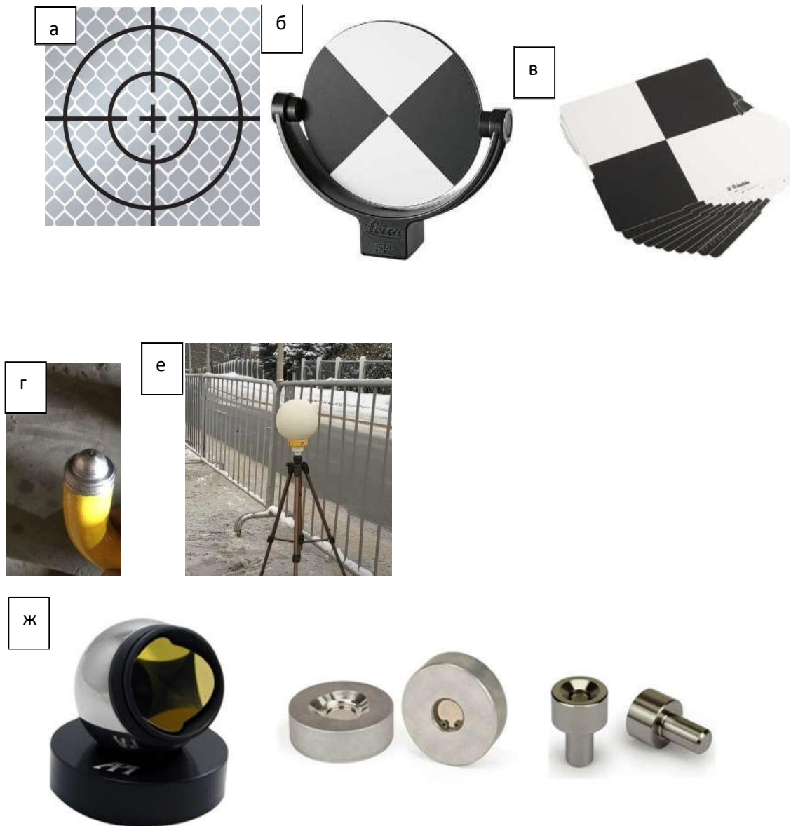
Рисунок 3.13 – Основні види марок при геодезичних спостережень а-в – плоскі контрастні марки; г- Г-подібні; е-спеціальні сфери з відбивачем; ж- відбивач для лазерного трекера
