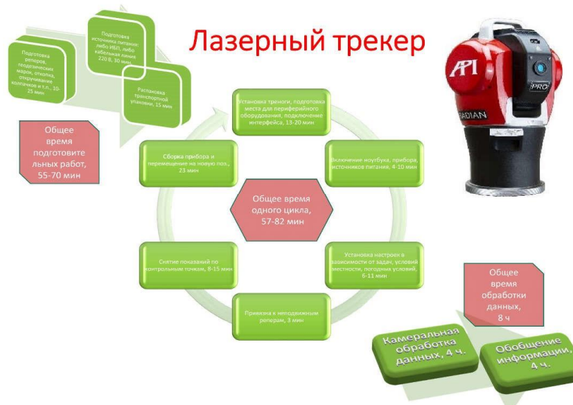
Рисунок 3.18– Послідовність технологічних операцій та норм часу під час роботи з лазерним трекером
