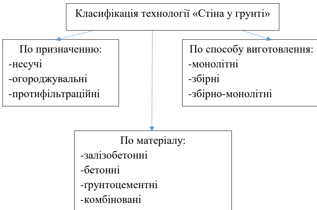
Рисунок 1.4 – Класифікація технології «стіна в ґрунті»
