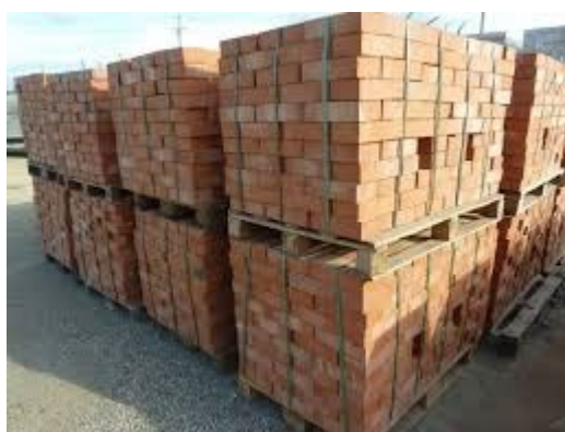
Рисунок 1.4 – Укладення цегли на піддоні з закріпленням стрічковими обв'язками.
