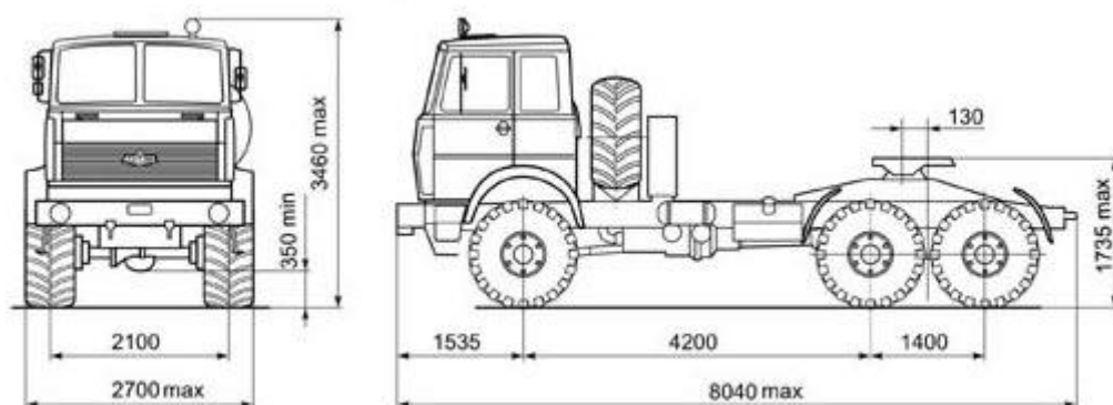
Рисунок 2.3 - Габаритні розміри сідельного тягачу МАЗ-642205-220
