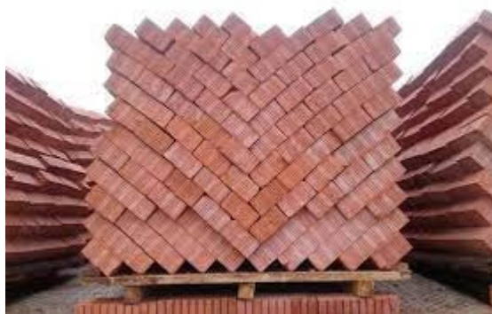
Рисунок 1.3 – Укладення цегли на піддоні «ялинкою»
