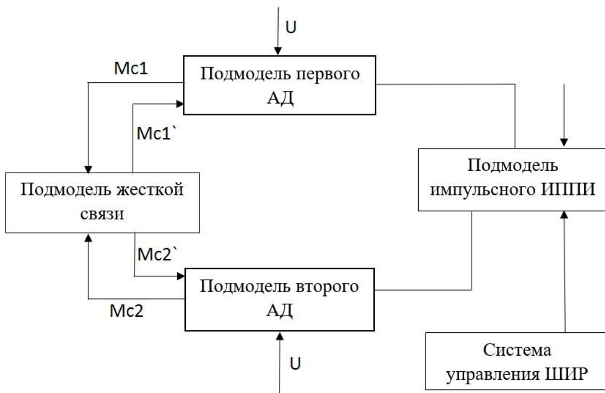
Рисунок 2.1 – Структура імітаційної моделі асинхронного дводвигунного електроприводу
