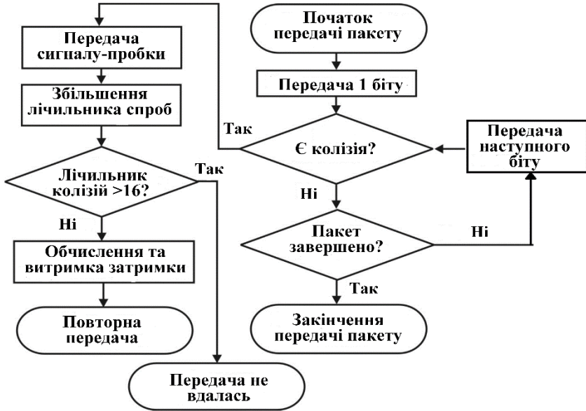
Рисунок 1.2 - Алгоритм передачі пакету
