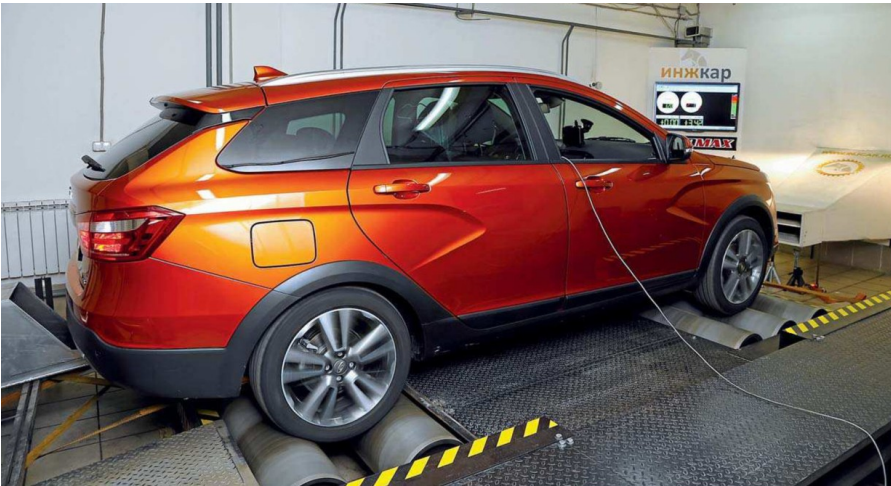
Рисунок 2.4 - Процес вимірювання тягово-швидкісних характеристик автомобіля на роликовому стенді
