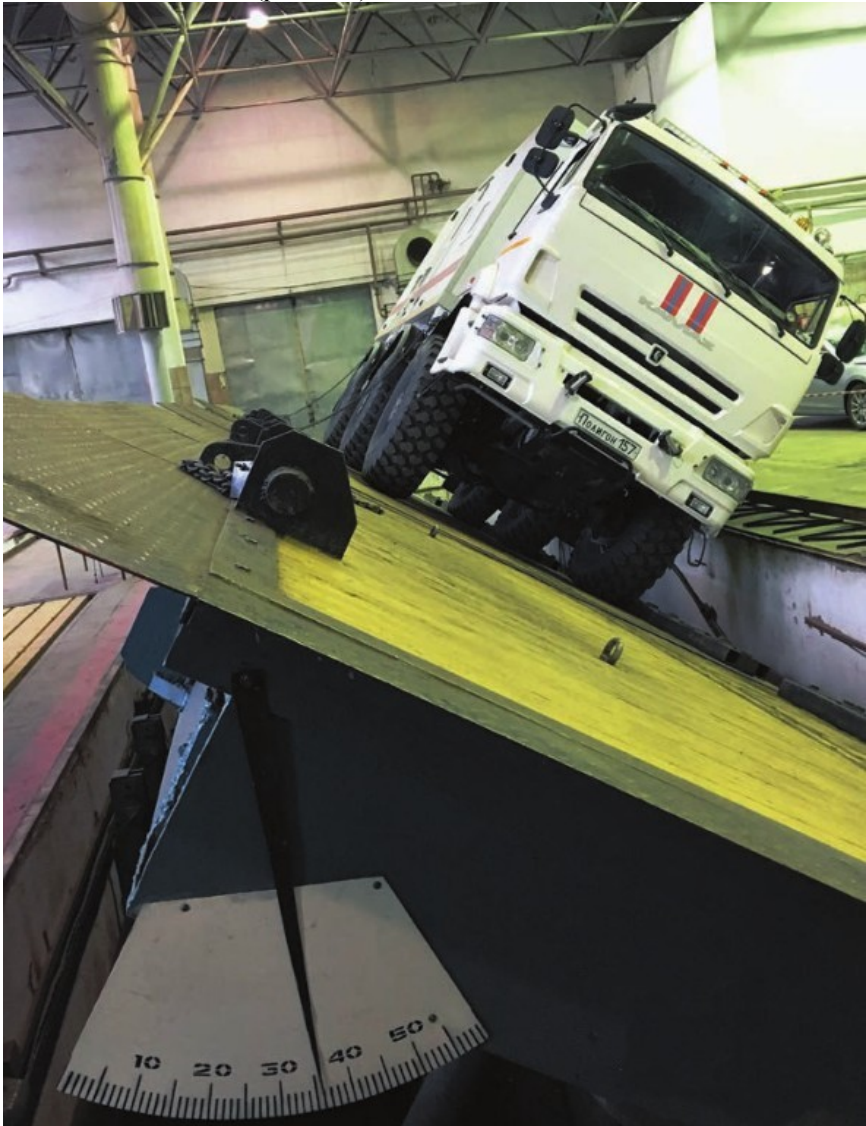
Рисунок 2.8 - Визначення кута поперечної (бічної) стійкості на стенді
