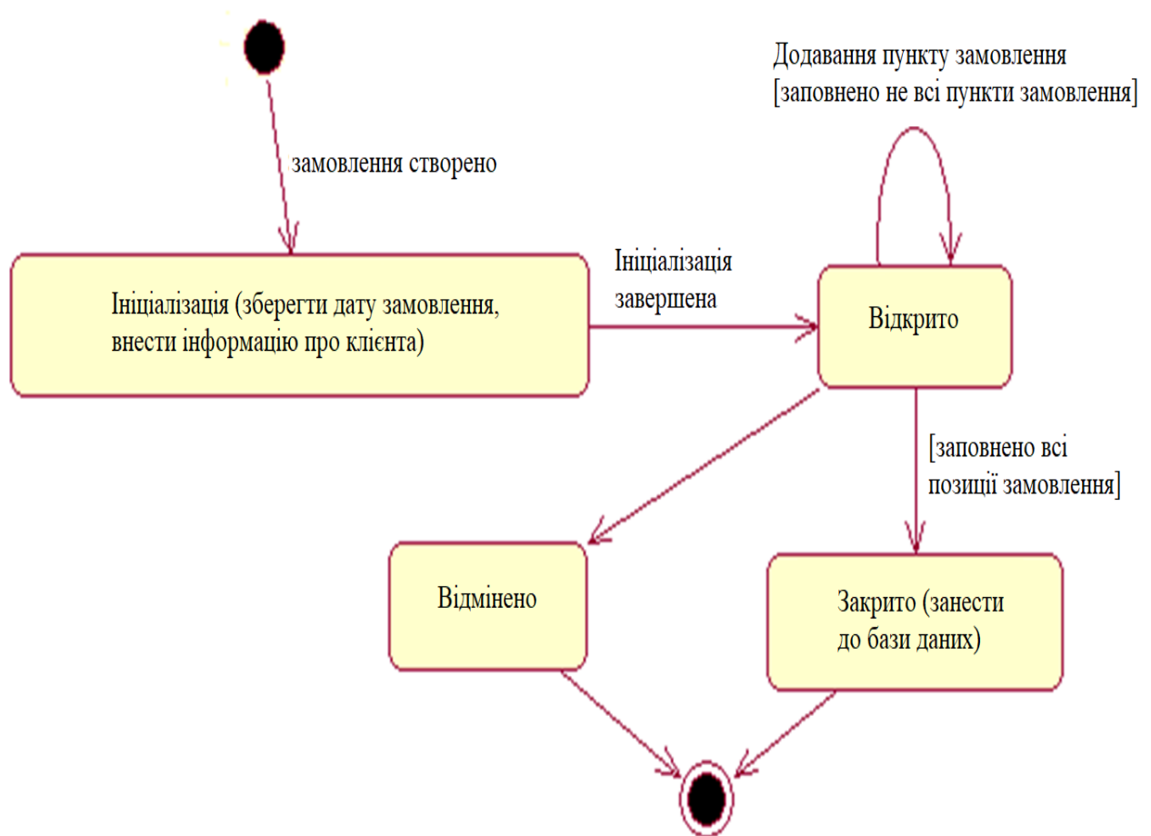
Рисунок 3.4 – Загальна схема функціонування програмного забезпечення для підтримки діяльності онлайн каси продажу квитків у вигляді діаграмі станів, поданої
