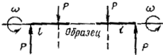
Рисунок 1.6 – Схема навантаження при випробуваннях за ГОСТ 25.502-79 (чистий вигин)
