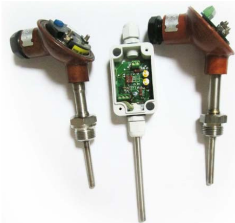
Рисунок 2.3 – Різні варіанти форми перетворювачів
