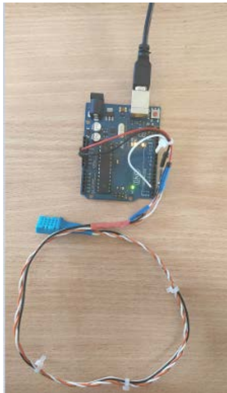
Рисунок 2.9 – Прототип підсистеми вимірювання температури та вологості
