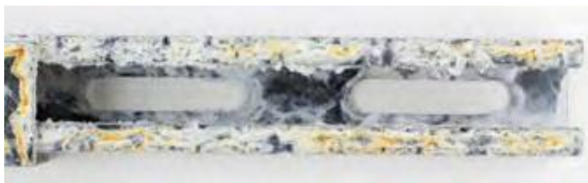
Рисунок 5.19 – Коричневі розводи на оцинкованому сталевому профілі, після випробування в соляному тумані 200 годин. Корозія сталі відсутня [13]
