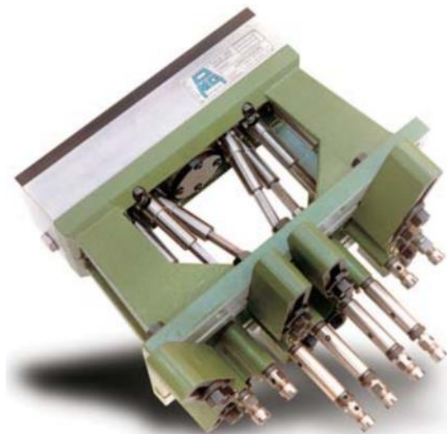
Рисунок 4.3 – Зображення револьверної головки з лінійною підставкою [11]
