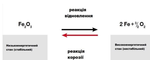
Рисунок 5.1 – Хімічні реакції за участю заліза в ході корозії і процесу відновлення металу [13]
