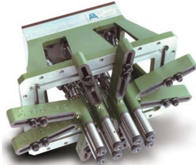
Рисунок 4.4 – Зображення револьверної головки з прямокутною підставкою [11]
