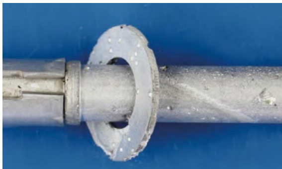
Рисунок 5.7 – Приклад точкової корозії на виробі з нержавіючої сталі [13]
