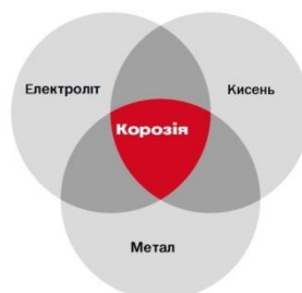
Рисунок 5.2 – Умови протікання реакції атмосферної корозії [13]
