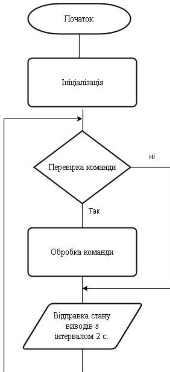
Рисунок 3.1 - Блок-схема алгоритму роботи модуля
