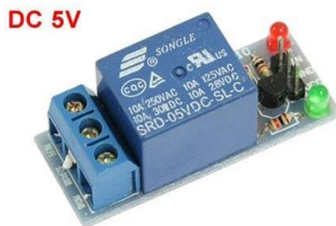
Рисунок 1.5 - Контактне реле SRD(T73) 5V (SRD-05VDC-SL-C)
