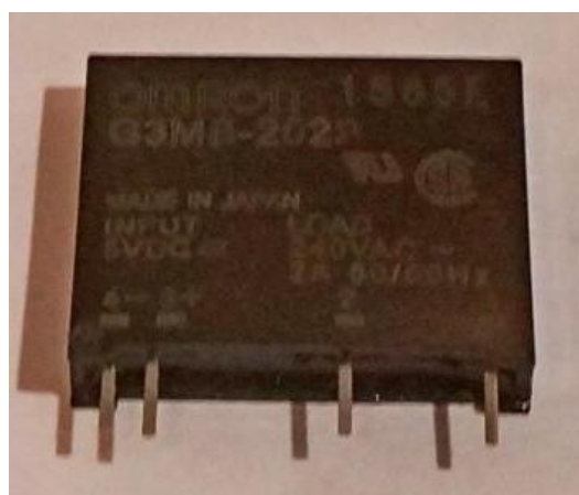
Рисунок 1.6 - Твердотільне малогабаритне реле Omron
