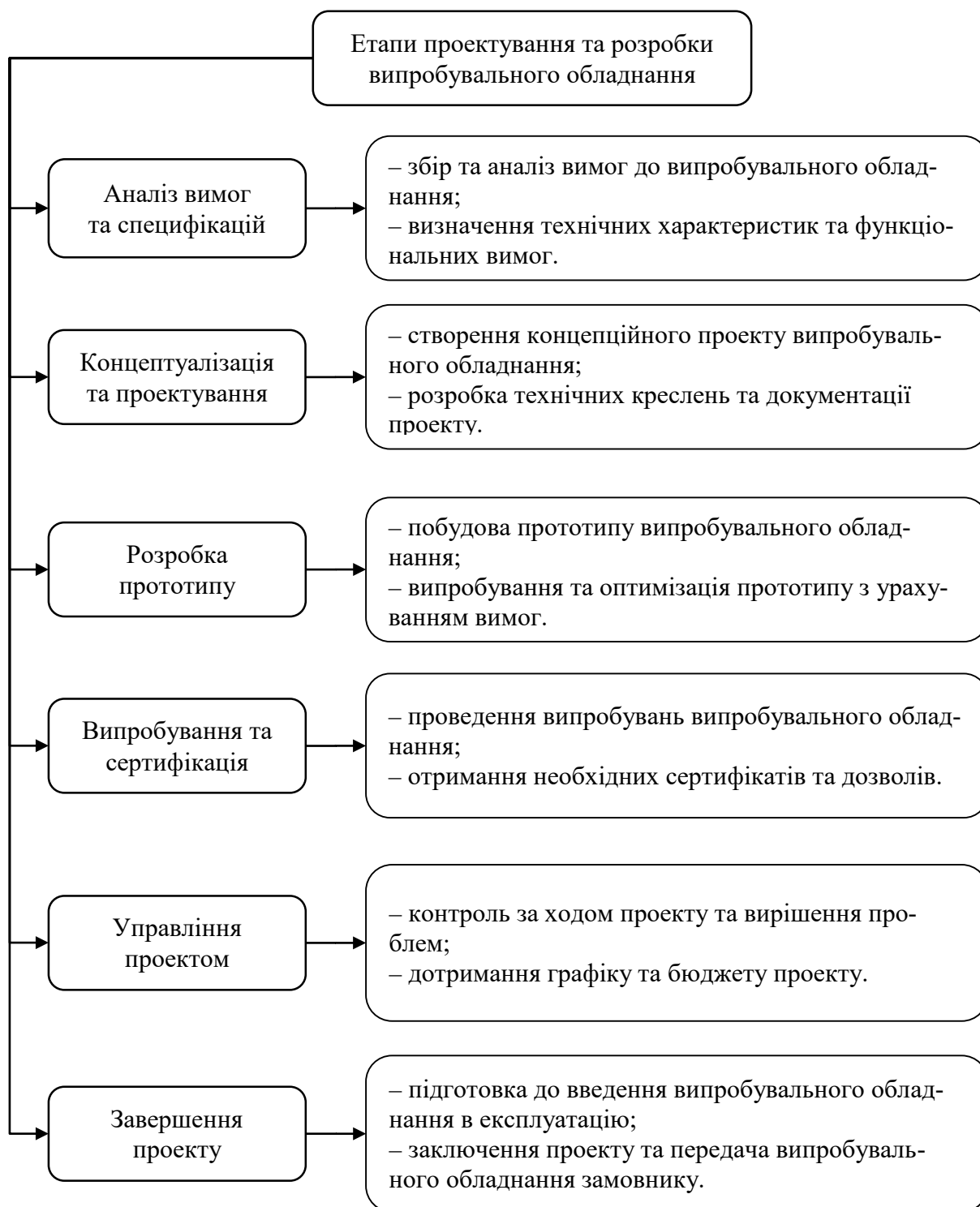
Рисунок 1.2 – Схема етапів проектування та розробки випробувального обладнання
