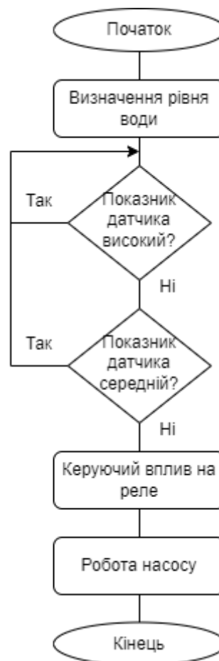
Рисунок 2.3 – Схема алгоритму контролю подачі води в бак [32]
