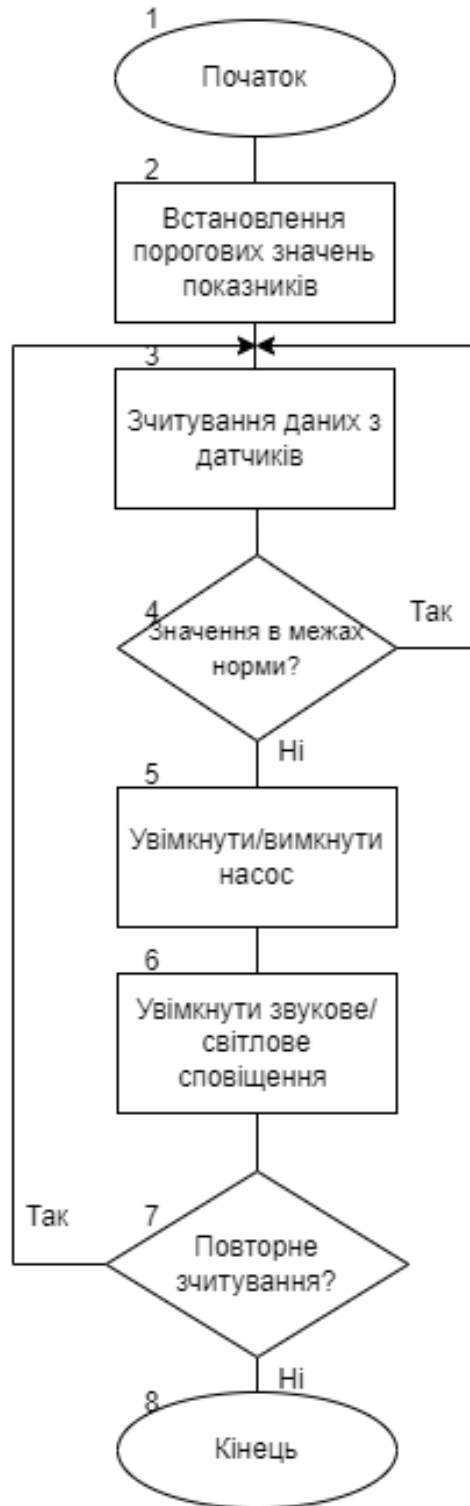
Рисунок 4.9 – Узагальнений алгоритм роботи підсистеми моніторингу
