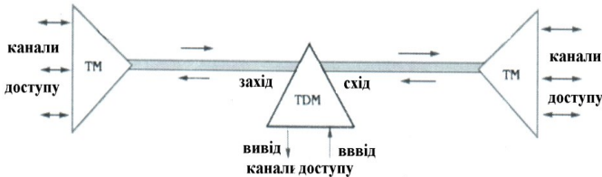
Рисунок 4.10 - Топологія «послідовне лінійне коло» на ТМ та ТДМ зі 100% резервуванням типу 1+1, яка використовує основний та резервний агрегатні виходи (канали прийому-передачі);
