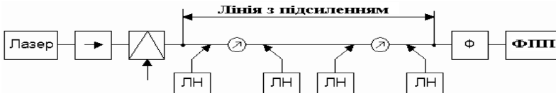
Рисунок 6.3 - Солітонна ВОСПІ з раманівським підсилювачем
