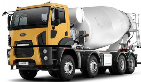
Рисунок 3.7 - Бетонозмішувач FORD TRUCK 4142M
